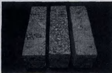
图 2 免蒸压混凝土外观(1000 次冻融循环)
